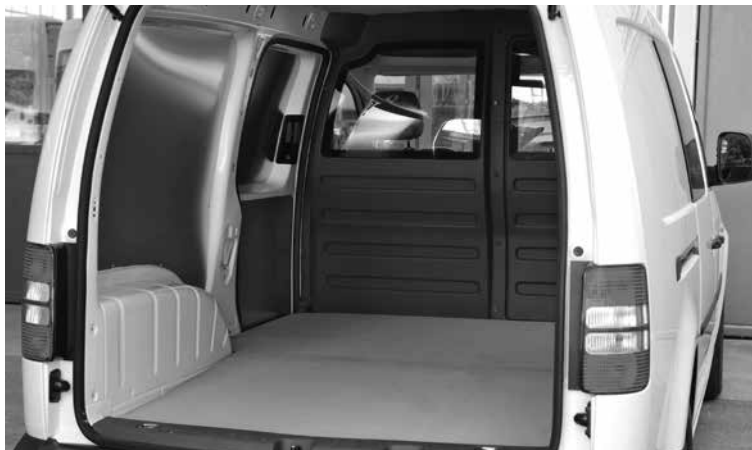
Revêtement du plancher et des parois latérales
